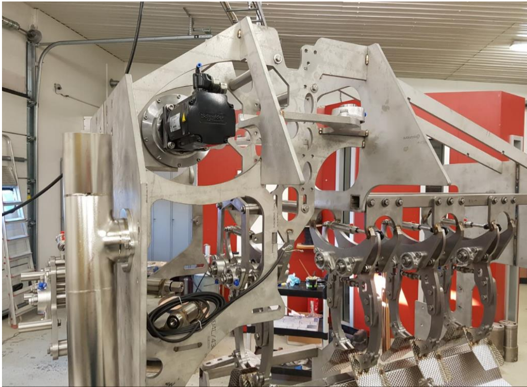
Figur 8. Motor for styring av kniver/aktuator.
